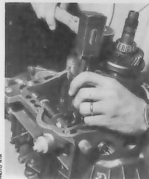
Dépose de la goupille de fixation du doigt de passage
