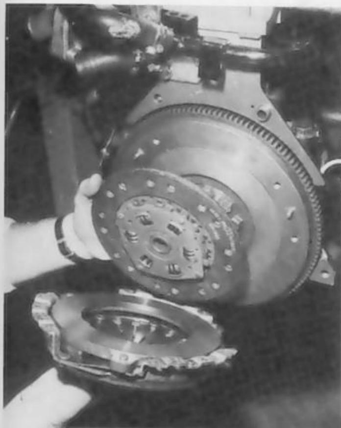
Remplacement du disque d'embrayage
