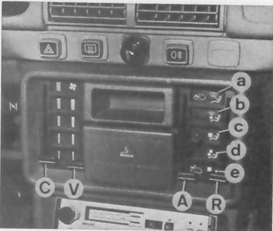
Commandes de chauffage-ventilation. (Photo RTA).
