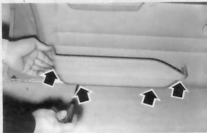
Déposer impérativement la boîte à gants pour déposer le garnissage de porte
