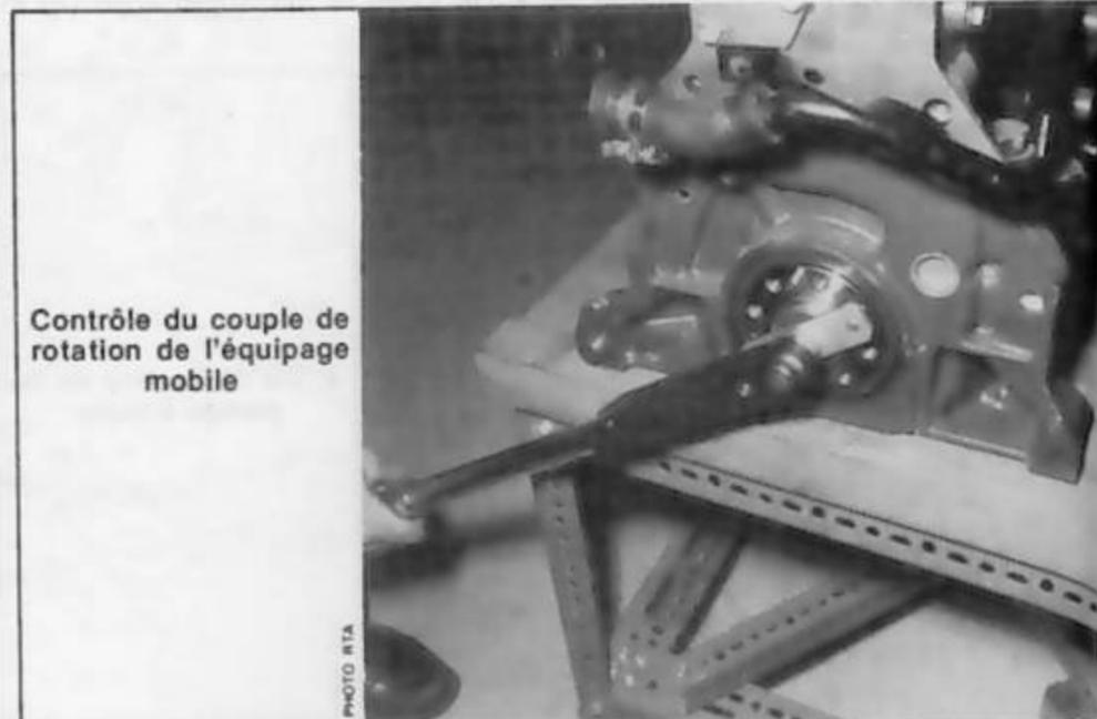
Contrôle du couple de rotation de l'équipage mobile
