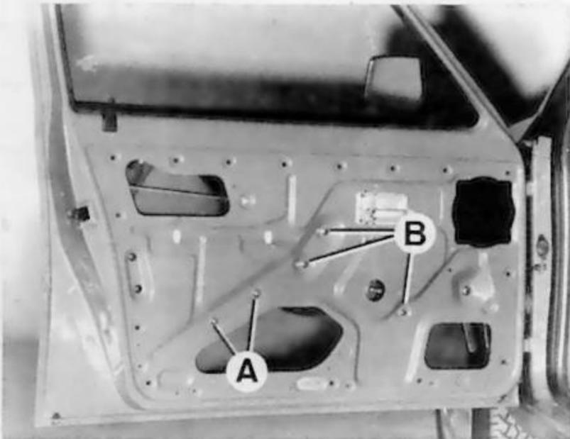
A. Fixation des guides de roulettes - B. Fixations du lève-glace sur le panneau de porte. Pour dégager la glace sortir le guide, déposer les lécheurs, les fixations du lève-glace et dégager la glace pointée en haut
