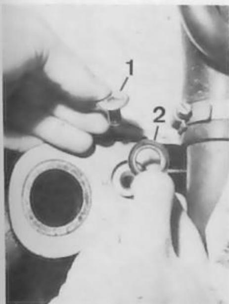
Fixation de la barre de torsion sur le bras de suspension
