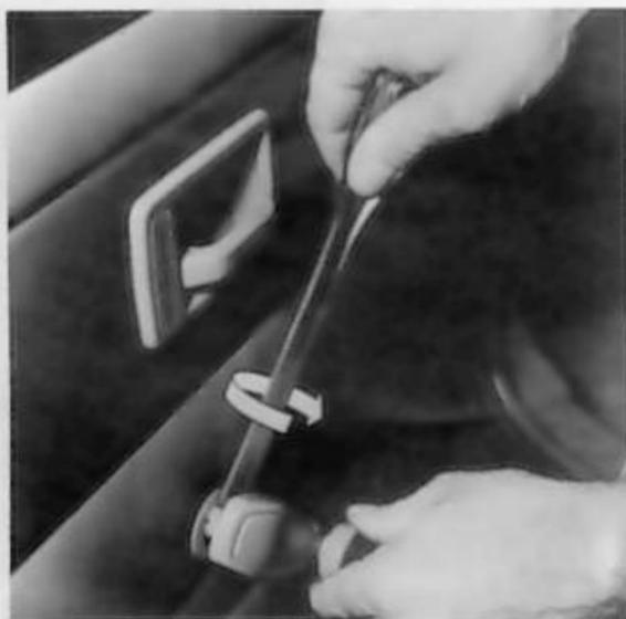
Dégager la manivelle lève-glace avec un tournevis plat en repoussant la bague conique
