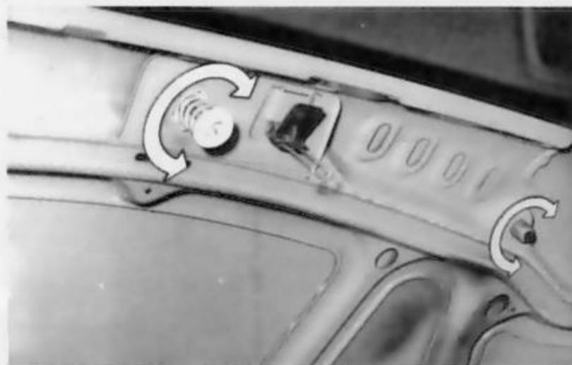
Le réglage en hauteur du capot moteur s'obtient en tournant le doigt de fermeture
