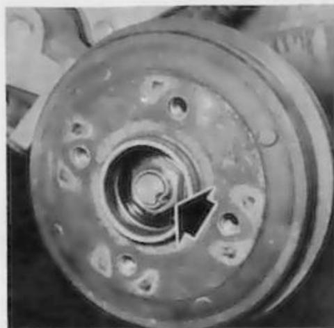
Freinage de l'écrou de moyeu
